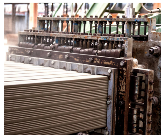
L'estrusione del prodotto "verde" dalla mattoniera
