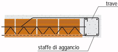
Travetto con armatura a traliccio
