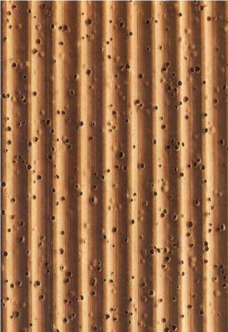
*Fig.16 – La superficie di un blocco alleggerito con polistirolo.*
