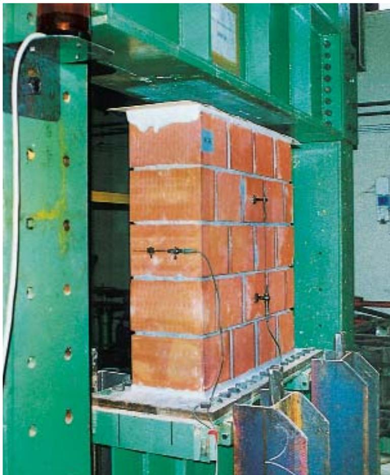
*L'apparecchiatura di prova con muretto posizionato per la determinazione della resistenza a carico verticale.*
