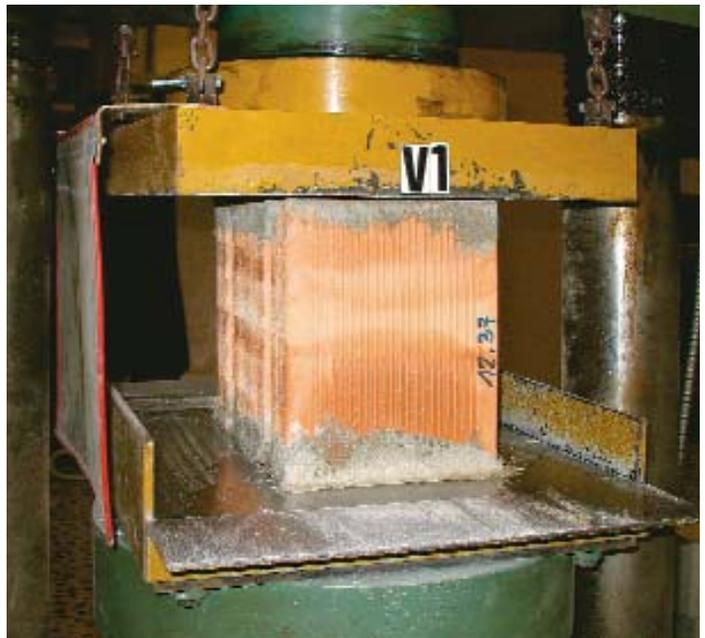
**Un blocco Alveolater® sotto pressa per la determinazione della resistenza meccanica in direzione parallela alla foratura.**
